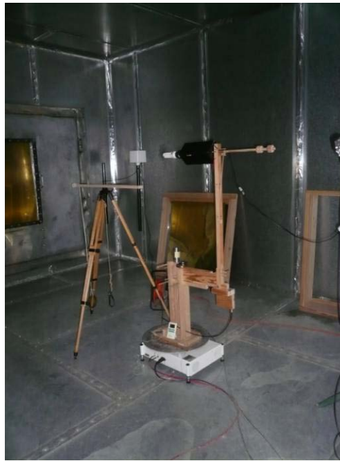
Figure 15 : Goniomètre pour la recherche de la direction d'émission maximale et pour la mesure des champs électrique et magnétique
