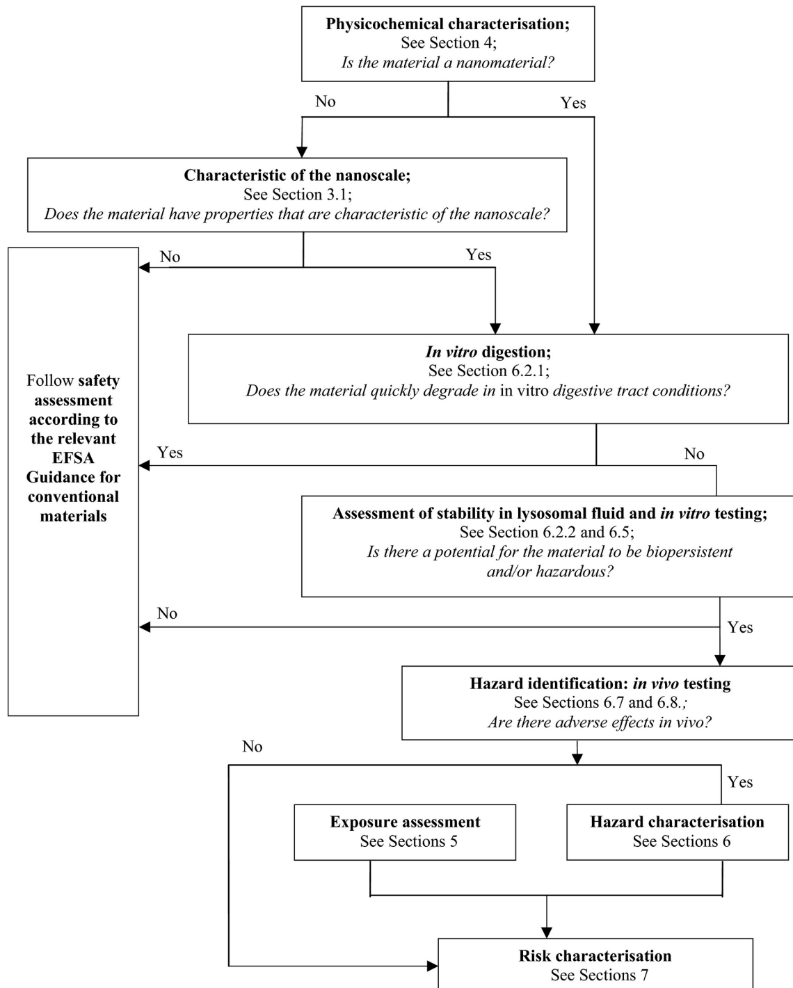
Figure 17 : logigramme proposé par l'EFSA présentant l'approche séquentielle de l'évaluation du risque des nanomatériaux (EFSA, 2018).
