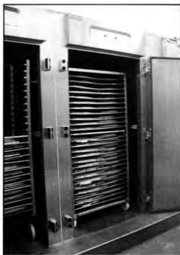
Photo 1 : enceintes pour le séchage-fumage des filets de saumon.
